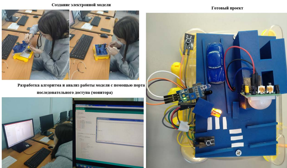
Рис. 6. Проект – модель «умного светофора»
